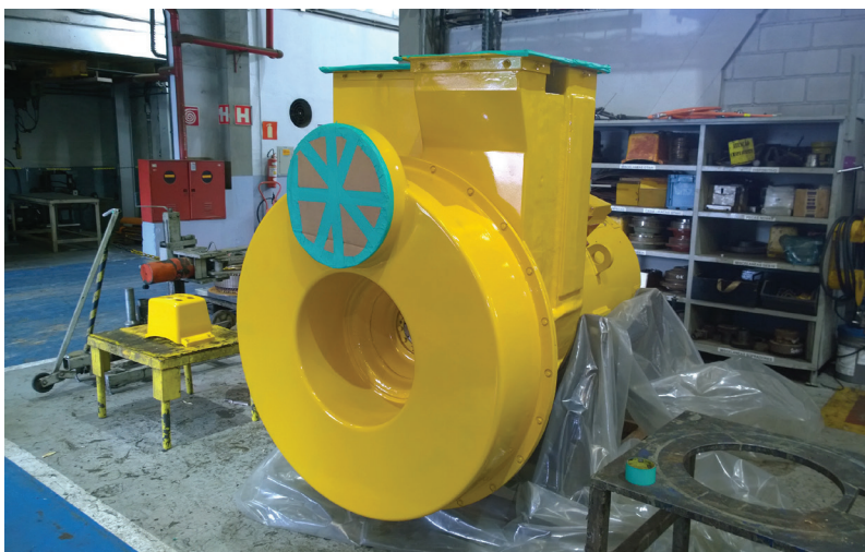
Alternador de tração GTA41 de um caminhão de mineração Komatsu, um componente essencial que gera a energia elétrica necessária para acionar os motores de tração do caminhão.
