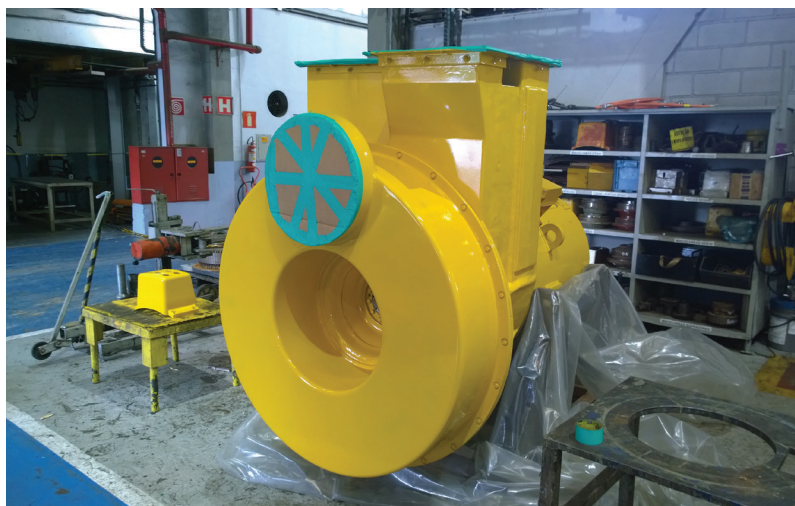
Тяговый альтернатор GTA41, снятый с горнодобывающего самосвала Komatsu, — ключевой компонент, вырабатывающий электроэнергию, необходимую для привода тяговых двигателей самосвала.
